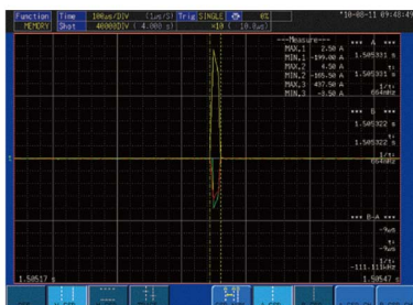
上圖為三相輸出短路自動波形，SCP 異常
